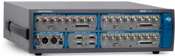
APx58xB Series 8 & 16 채널 모듈방식의 분석기 멀티채널 기기 테스트에 이상적이며 APx58xB는 8 채널 아날로그 출력과 8 채널 또는 16 채널 아날로그 입력과 모든 APx 디지털 옵션을 지원합니다.
